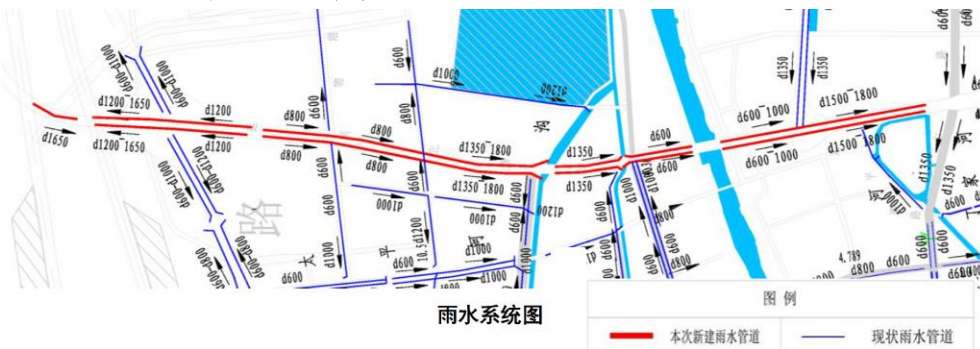
图 2-14 本项目雨水管网系统图
