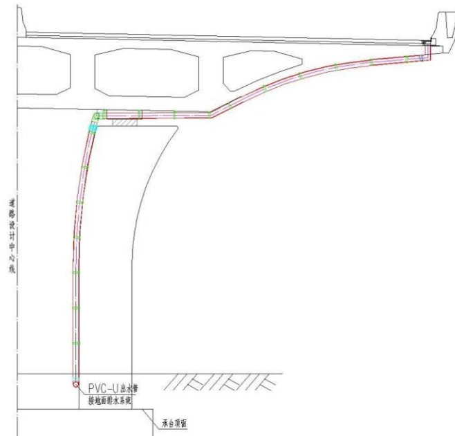
图 2-15 高架落水管布置示意
